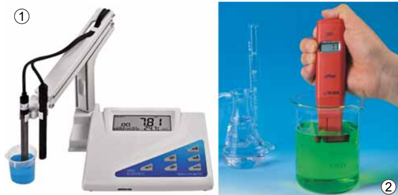
Рис. 14.2. рН-метри. 1. Стаціонарний. 2. Портативний
